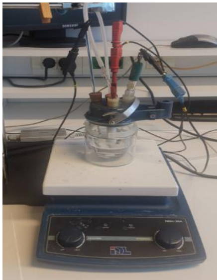
Slika 23. Prikaz elektrokemijske ćelije
