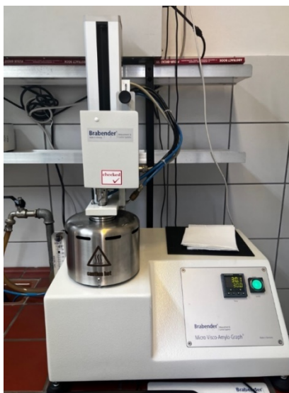
Slika 7. Mikro visko-amilograf korišten u laboratoriju
