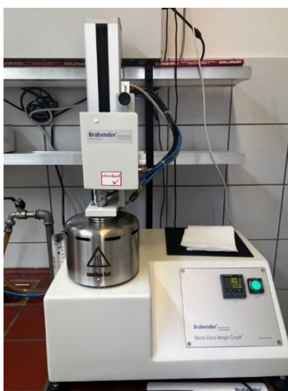
Slika 7. Mikro visko-amilograf korišten u laboratoriju
