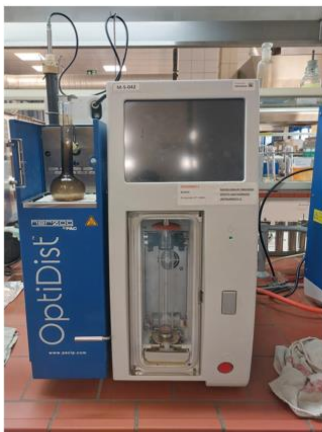
Slika 29. Aparatura za automatsku destilaciju te primjer ispisa rezultata mjerenja
