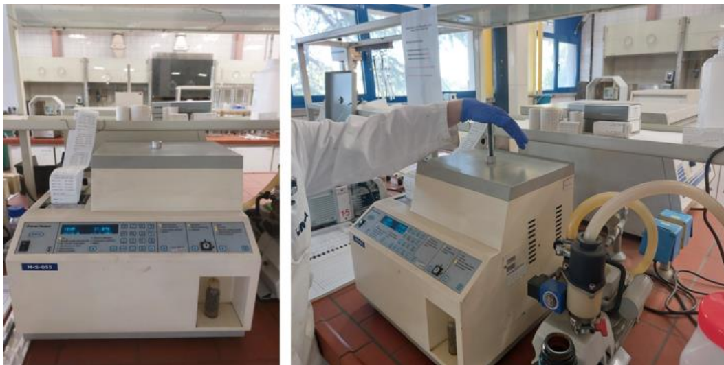
Slika 38. Termostatirana komora za određivanje tlaka pare uzorka
