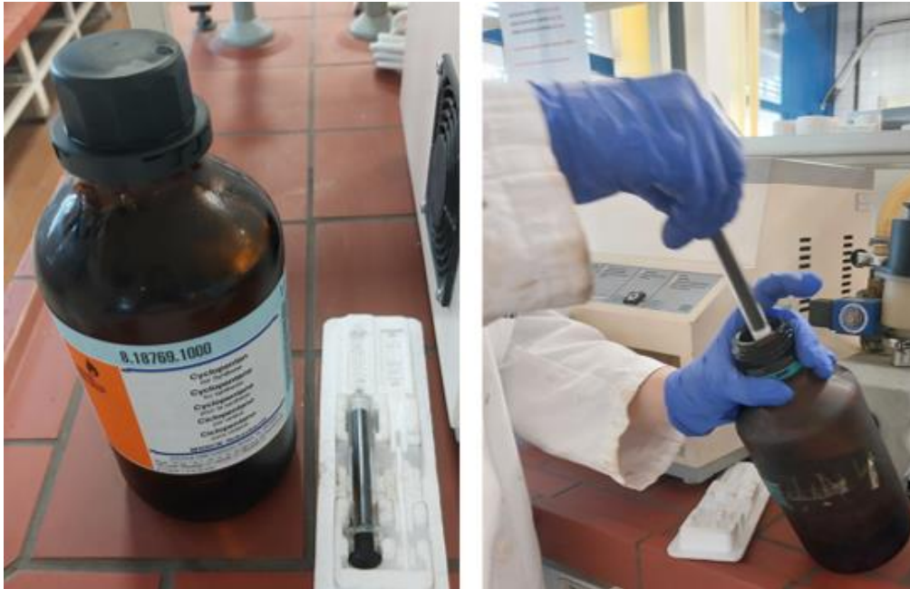
Slika 37. Uzimanje uzorka iz boce pomoću štrcaljke
