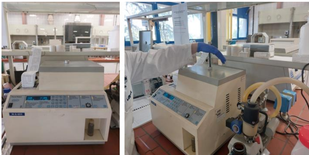
Slika 38. Termostatirana komora za određivanje tlaka pare uzorka
