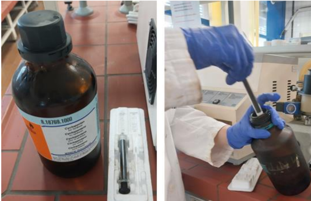
Slika 37. Uzimanje uzorka iz boce pomoću štrcaljke
