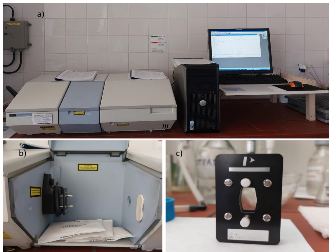
Slika 43. a) IR spektrometar za analizu količine benzena u FCC benzinu, b) mjesto gdje se postavlja ćelija s uzorkom za analizu, c) ćelija za uzorak
