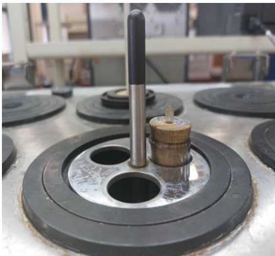
Slika 35. Čelični cilindar s epruvetom (lijevo) i vodena kupelj u koju se smješta čelični cilindar (desno),
