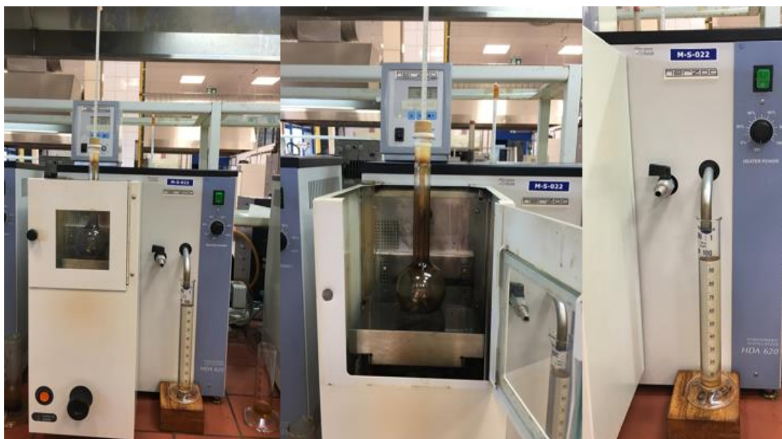
Slika 28. Prikaz aparature za ručnu destilaciju
