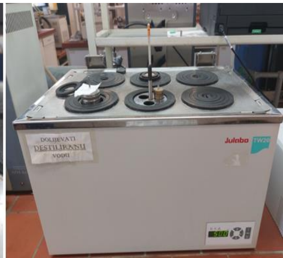
Slika 35. Čelični cilindar s epruvetom (lijevo) i vodena kupelj u koju se smješta čelični cilindar (desno),
