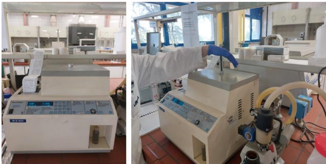
Slika 38. Termostatirana komora za određivanje tlaka pare uzorka
