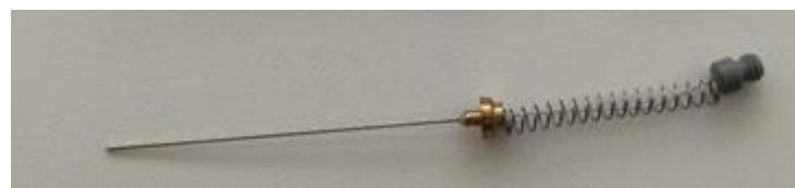
**Slika 12.** Sivo vlakno divinilbenzen/karboksen/polidimetilsilosan (DVB/CAR/PDMS)
