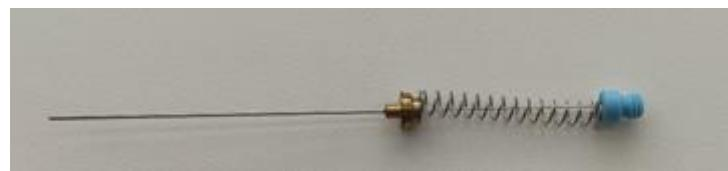
**Slika 11.** Svijetlo plavo vlakno polidimetilsilosan/divinilbenzen (PDMS/DVB)
