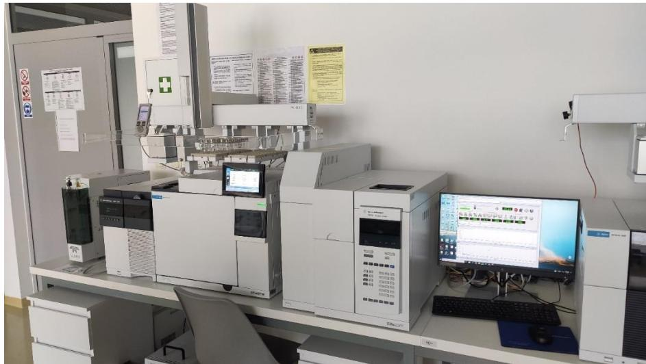
**Slika 13.** Vezani sustav plinska kromatografija-spektrometrija masa (GC-MS)
