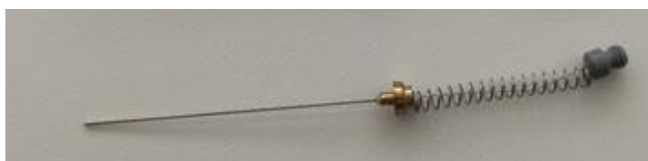
Slika 12. Sivo vlakno divinilbenzen/karboksen/polidimetilsiloksan (DVB/CAR/PDMS)
