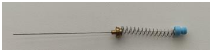
Slika 11. Svijetlo plavo vlakno polidimetilsiloksan/divinilbenzen (PDMS/DVB)
