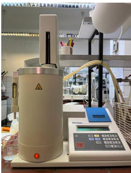
Slika 5. Uređaj za određivanje broja padanja
