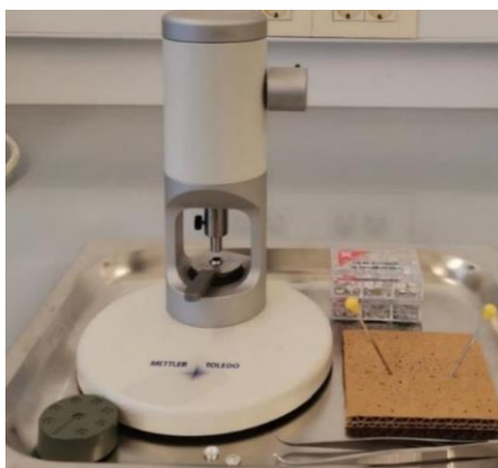
Slika 20. Preša za pripremanje uzoraka za DSC analizu
