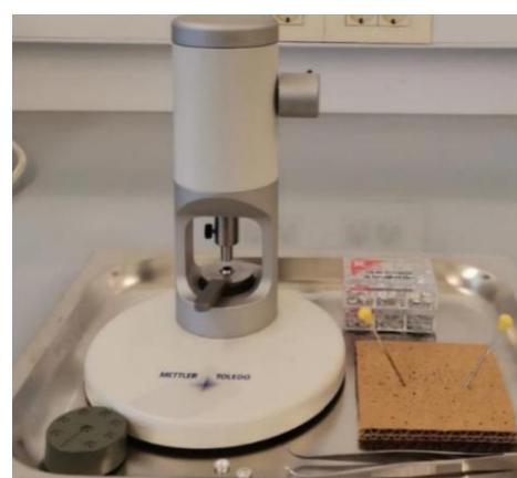
Slika 20. Preša za pripremanje uzorka za DSC analizu
