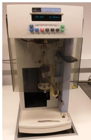
Slika 22. Aparatura za termogravimetrijsku analizu Perkin-Elmer Pyris 1 TGA
