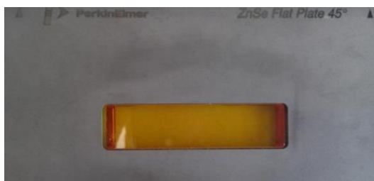
Slika 19. ZnSe 45° kristal u FT-IR uređaju
