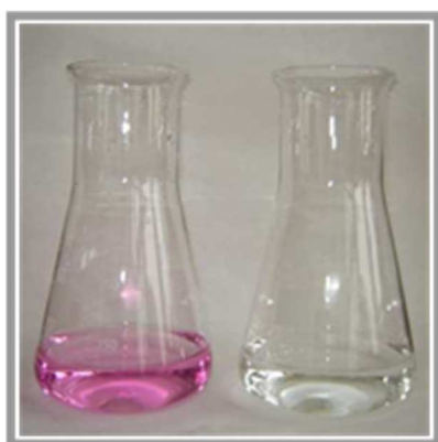
Slika 2.2. Prikaz prijelaza boje pri kompleksometrijskoj titraciji u točki ekvivalencije.
