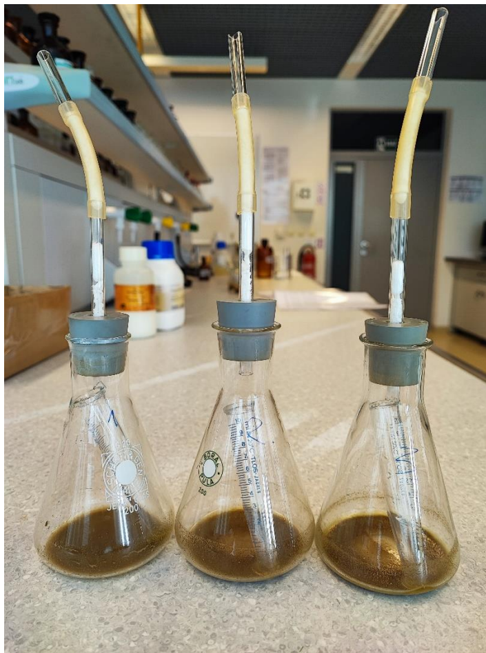
Slika 12. Određivanje karbonata u tlu gravimetrijskom metodom
