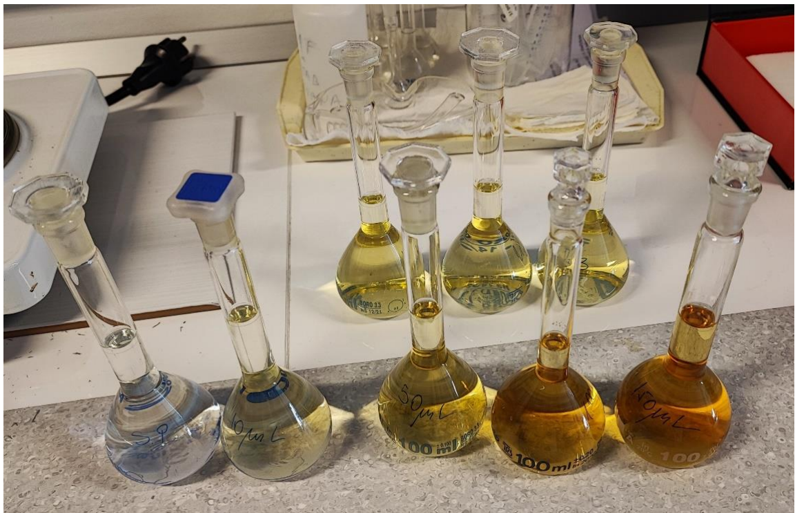
Slika 11. Pripremljeni uzorci standardnih otopina i tala za spektrofotometrijsko određivanje koncentracije amonijačnog dušika u tlu
