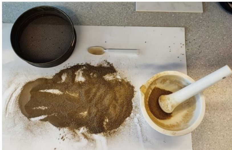
Slika 7. Usitnjavanje i prosijavanje uzoraka tala
