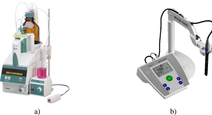
Slika 2.1. a) Automatski titrator „Metrohm 775 Dosimat“ ; b) pH-metar „Mettler Toledo“.
