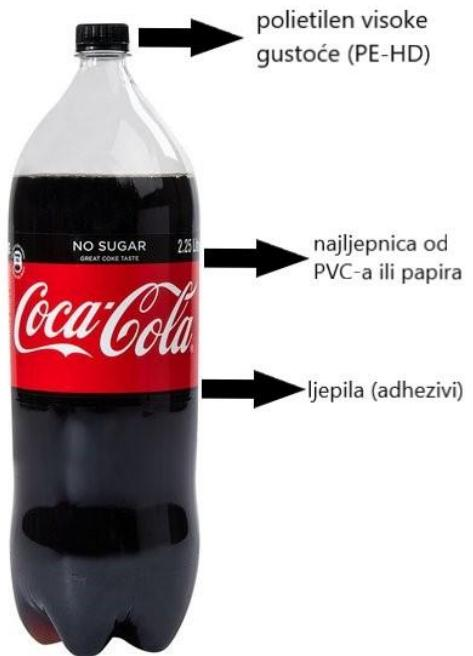
Slika 7. Dijelovi PET boce<sup>24</sup> koji se uklanjuju prije recikliranja
