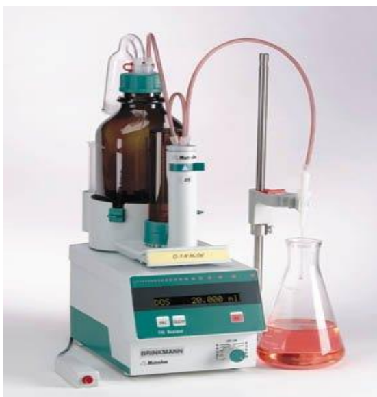
Slika 2.1. Uređaj: Automatski titrator “Metrohm 775 Dosimat”.
