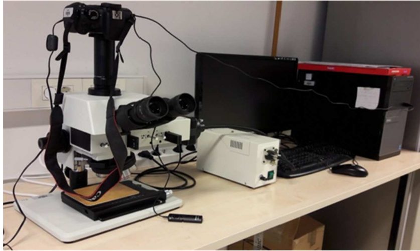
Slika 2.4 Svjetlosni mikroskop MXFMS-BD, Ningbo Sunny Instruments co.
