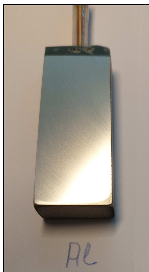
Slika 2.1 Izgled pripremljene elektrode od Al-legure
