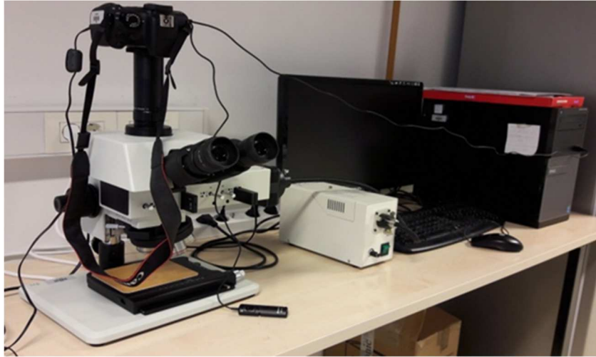
Slika 2.4 Svjetlosni mikroskop MXFMS-BD, Ningbo Sunny Instruments co.
