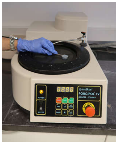
Slika 2.2. Priprema radne površine AA 5754 legure na uređaju Metkon Forcipol 1V
