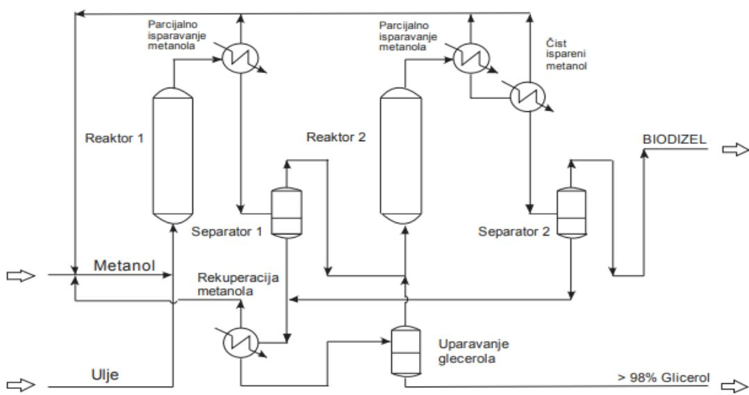
Slika 3. Shema dobivanja biodizela Esterip-H procesom<sup>9</sup>
