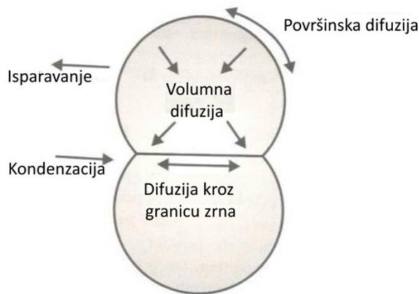
Slika 8. Prikaz mehanizama prijenosa mase<sup>15</sup>
