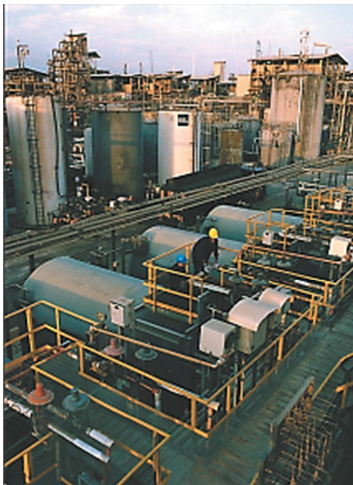
Slika 1.16. Spremnici za skladištenje broma u postrojenju 20
