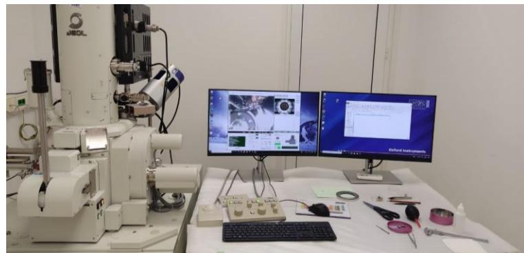
Slika 20. SEM/EDS JEOL JSM - 7610F Plus.
