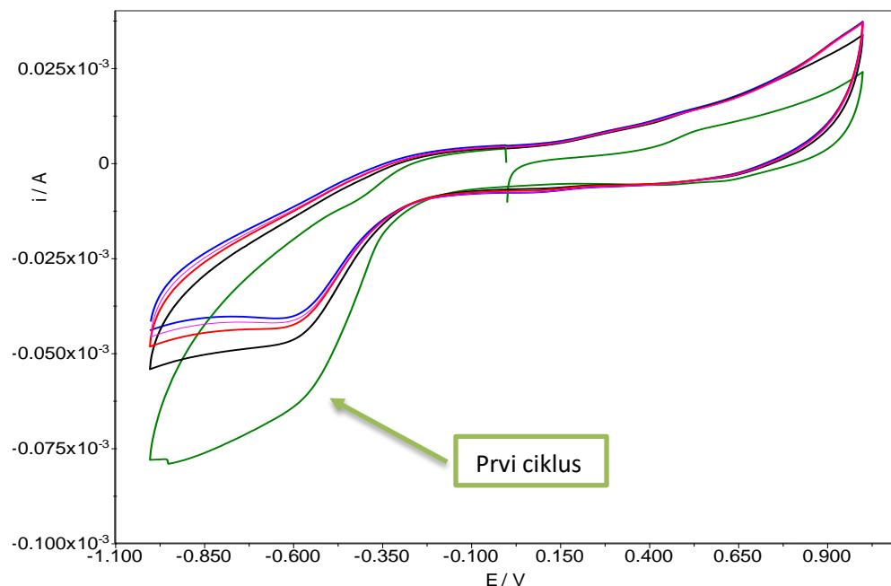
Slika 31. Nemodificirana elektroda u  $0,1 \text{ mol dm}^{-3}$  otopini  $\text{KNO}_3$  – 5 ciklusa s brzinom promjene potencijala 50 mV/s.
