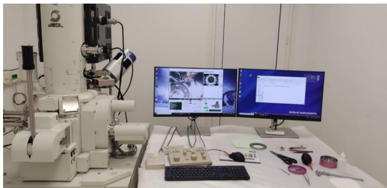
Slika 20. SEM/EDS JEOL JSM - 7610F Plus.
