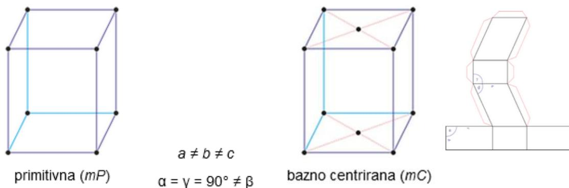
**Slika 15.** Grafički prikaz osi monoklinskog kristalnog sustava
