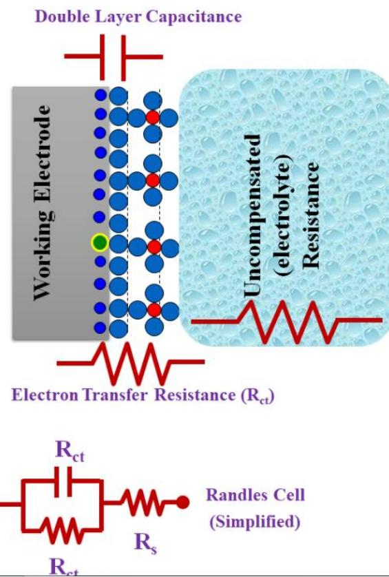
**Slika 9.** Jednostavna shema za opis EIS kruga i redoks reakcije koja se odvija na površini radnih elektroda u konvencionalnoj elektrokemijskoj ćeliji (tj. Sustav s tri elektrode).  $R_{ct}$  je otpor prijenosu naboja,  $R_s$  je otpor elektrolita, a  $C_{dl}$  je kapacitet dvostrukog sloja. [15]
