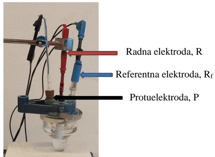
**Slika 18.** Troelektrodna čelija za elektrokemijska mjerena.
