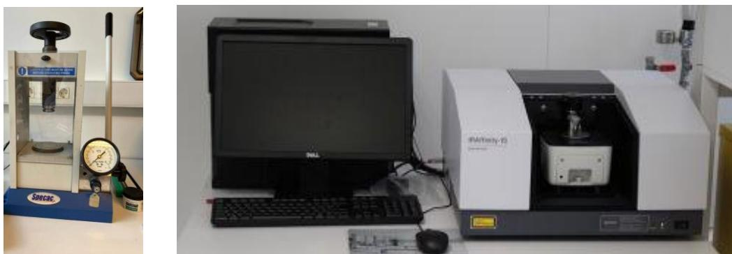
Slika 21. Preša za pravljenje pastila i uređaj za FT-IR analizu.
