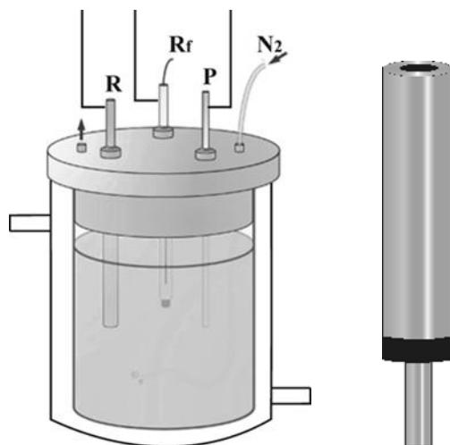
**Slika 16.** Shema aparature za elektrokemijska mjerena. R – radna elektroda, R<sub>f</sub> – referentna elektroda, P – protuelektroda. Tijelo radne elektrode
