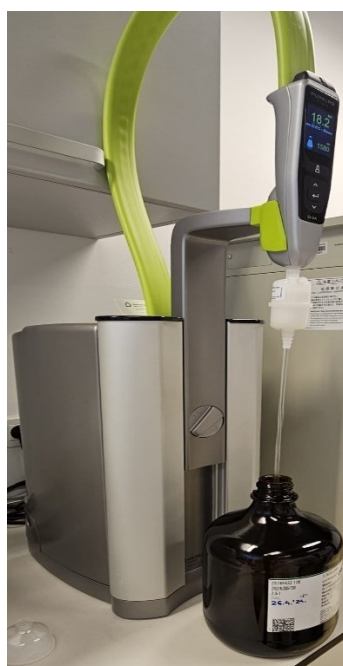
Slika 13. Uređaj za pročišćavanje vode
