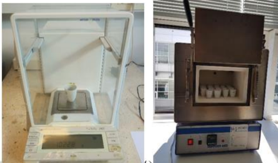
Slika 19. a) Vaganje približno 1 g brokule ; b) Žarna peć ispunjena porculanskim lončićima koji sadrže usitnjenu odvagu brokule
