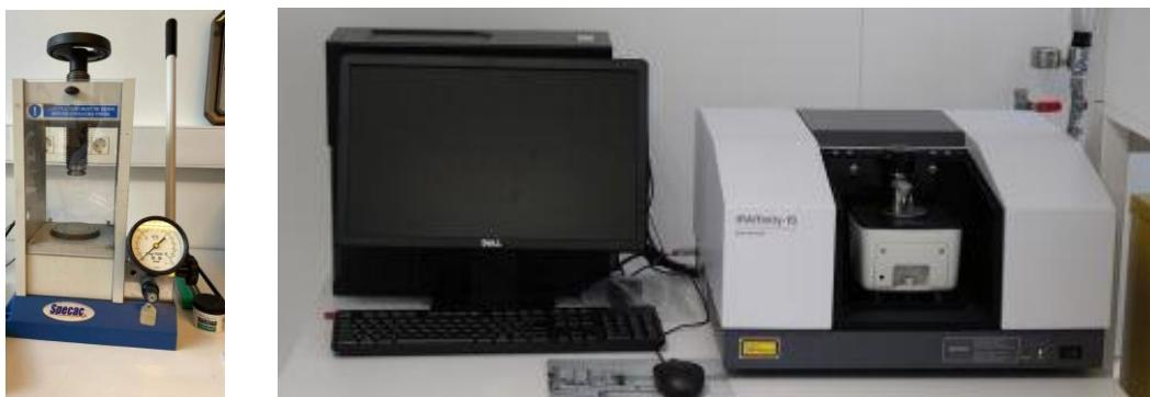
Slika 26. Preša za pravljenje pastila i uređaj za FTIR analizu.
