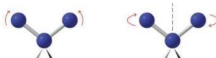
Slika 16. Simetrično i asimetrično rastezanje
