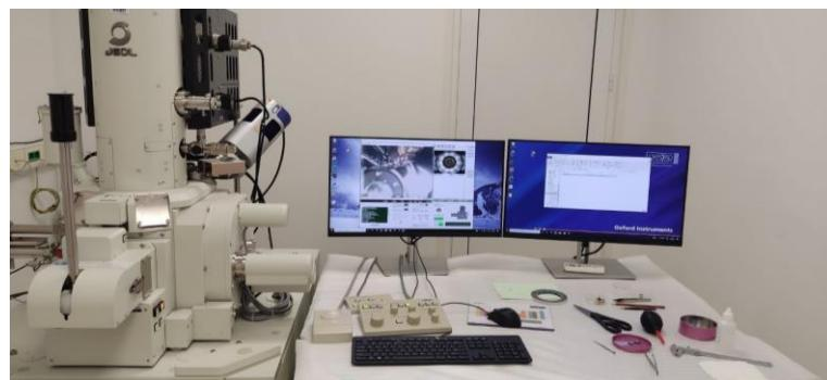
Slika 25. SEM/EDS JEOL JSM - 7610F Plus.
