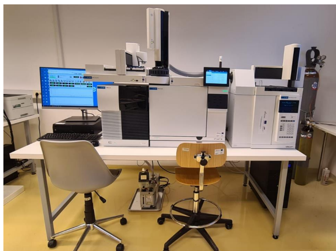
Slika 2.2. Plinski kromatograf sa spektrometrijom masa
