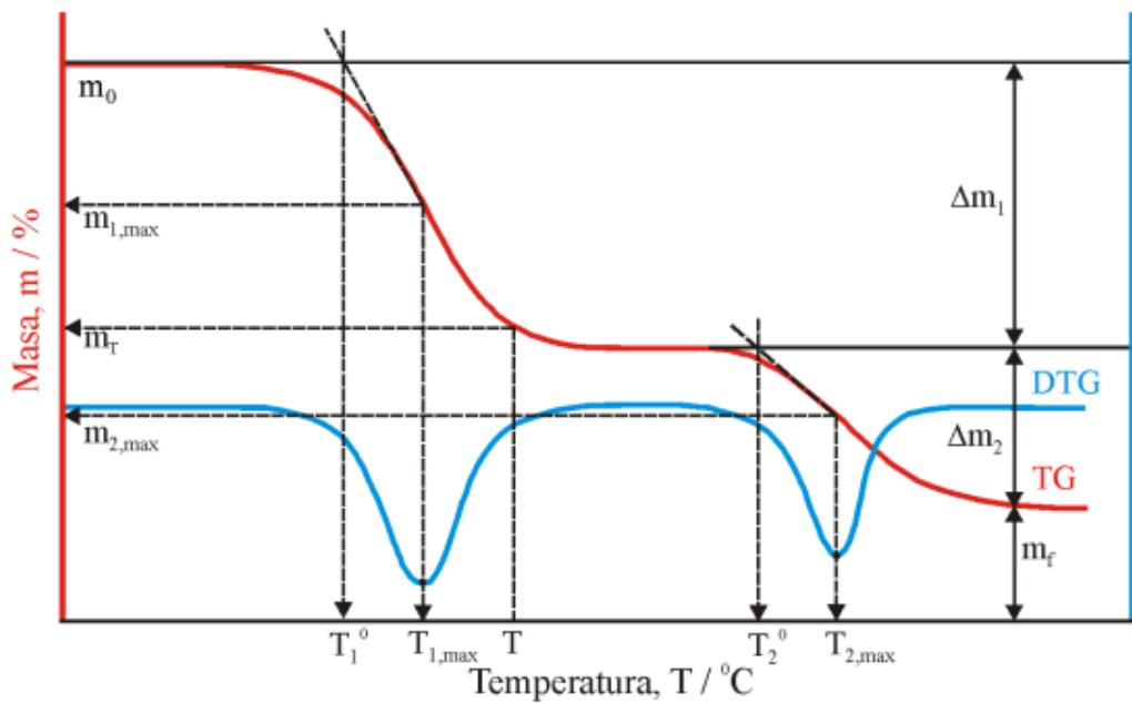
Slika 17. Određivanje značajki termogravimetrijskih krivulja <sup>29</sup>
