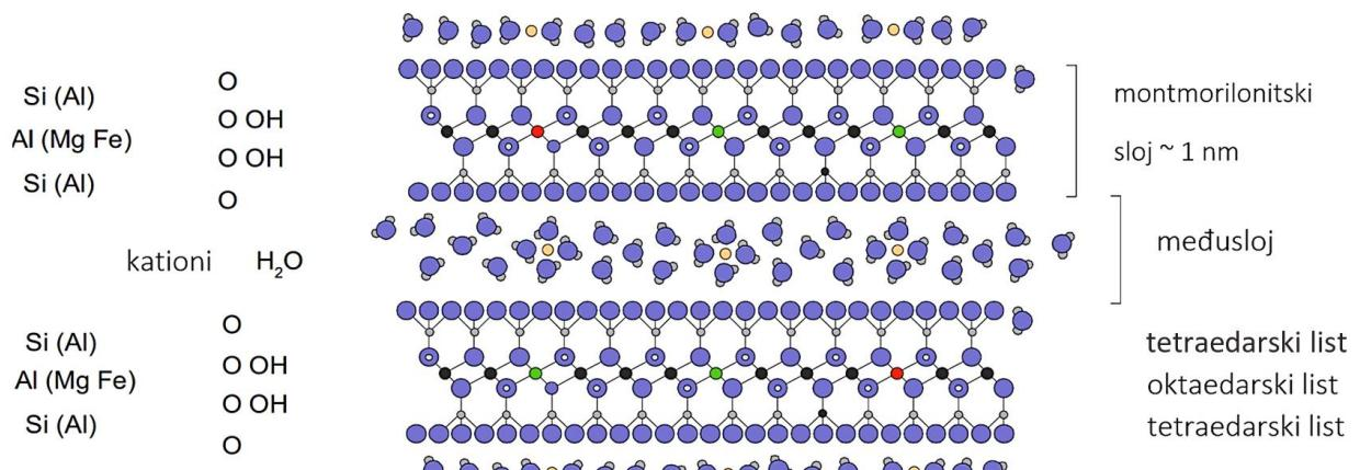
Slika 4. Struktura montmorilonita<sup>7</sup>
