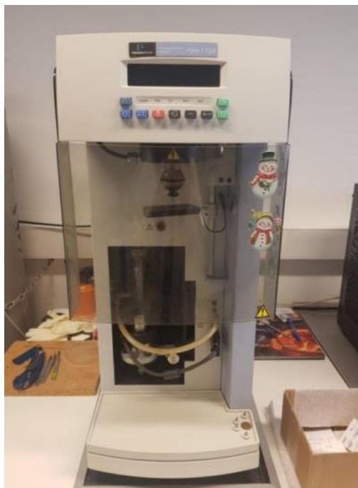
Slika 18. Uređaj za termogravimetrijsku analizu
