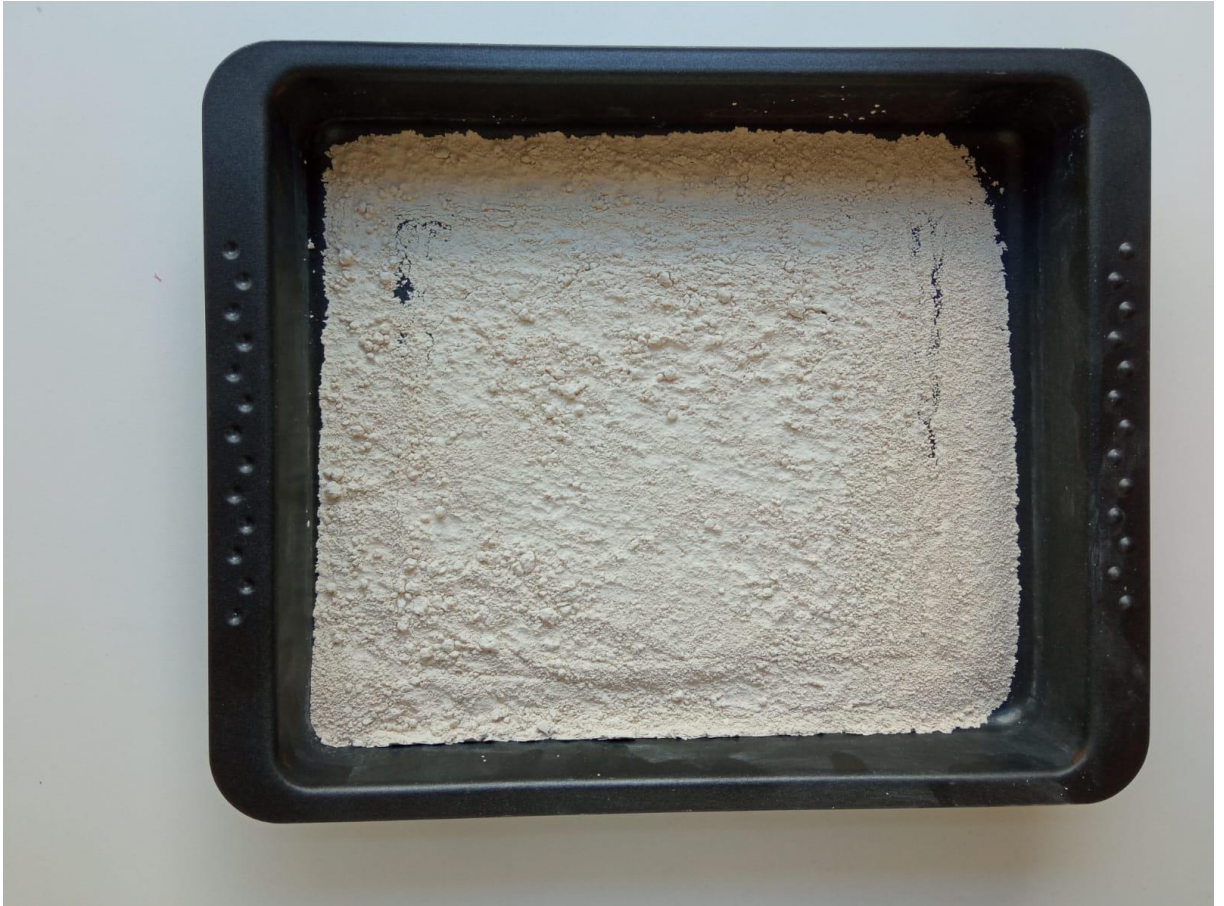
Slika 2.1. Usitnjene čestice zeolita NaX
