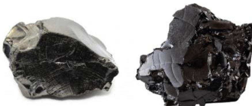
Slika 1.3.1. Uzorak staklastog ugljika
