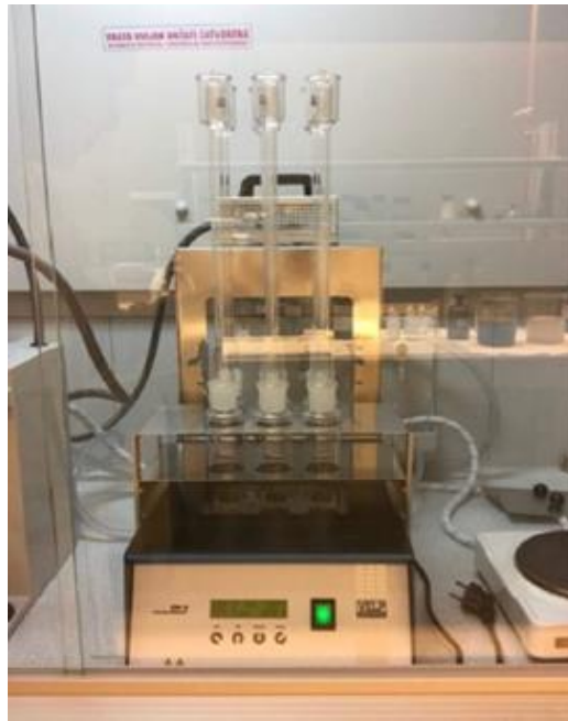
Slika 17. Kuhanje smjese u digestoru uz refluks
