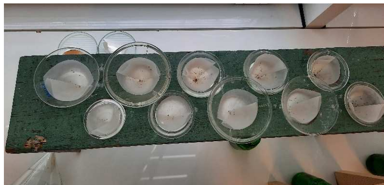
Slika 2.5. Filtriranje suspenzija nakon sorpcije
