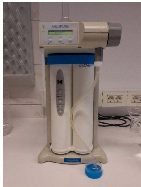
Slika 2.2. Uređaj „Millipore“ za pripremu ultračiste vode
