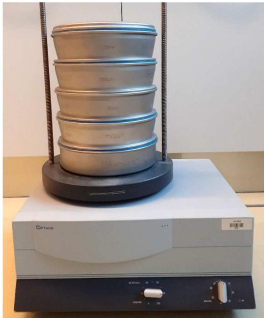
**Slika 2.6.** Uređaj za prosijavanje „Retsch AS 200 basic“
