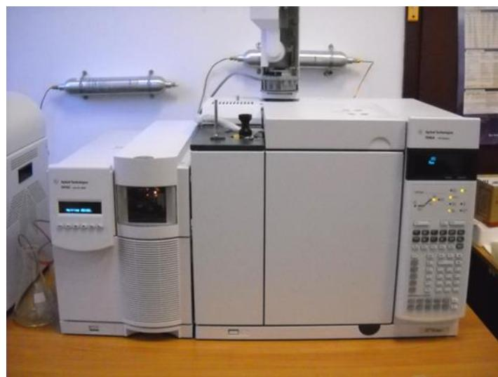
**Slika 16.** Vezani sustav plinska kromatografija-spektrometrija masa (GC-MS)
