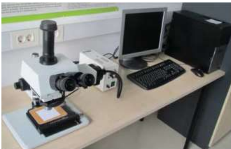
Slika 2.4. Optički mikroskop MXFMS-BD, Ningbo Sunny Instruments co.
