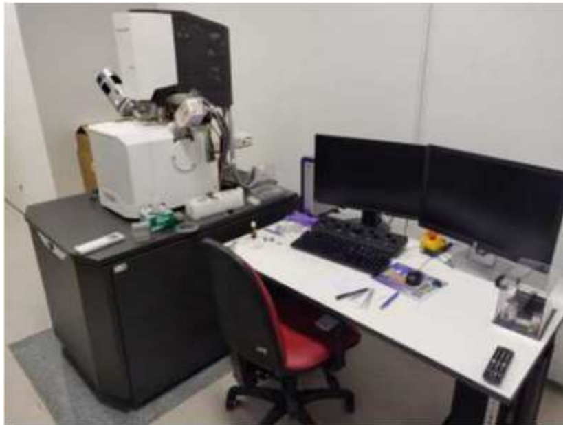
Slika 2.5. Pretražni elektronski mikroskop Quattro ESEM firme Termo Fisher Scientific.
