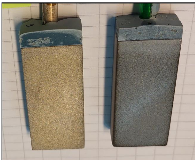
Slika 17. Al anoda (lijevo) i katoda (desno) nakon procesa elektrokoagulacije
