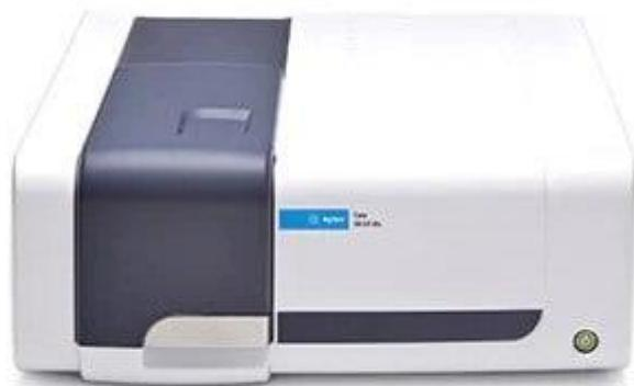
**Slika 16.** Agilent Cary 60 spektrofotometar<sup>26</sup>
