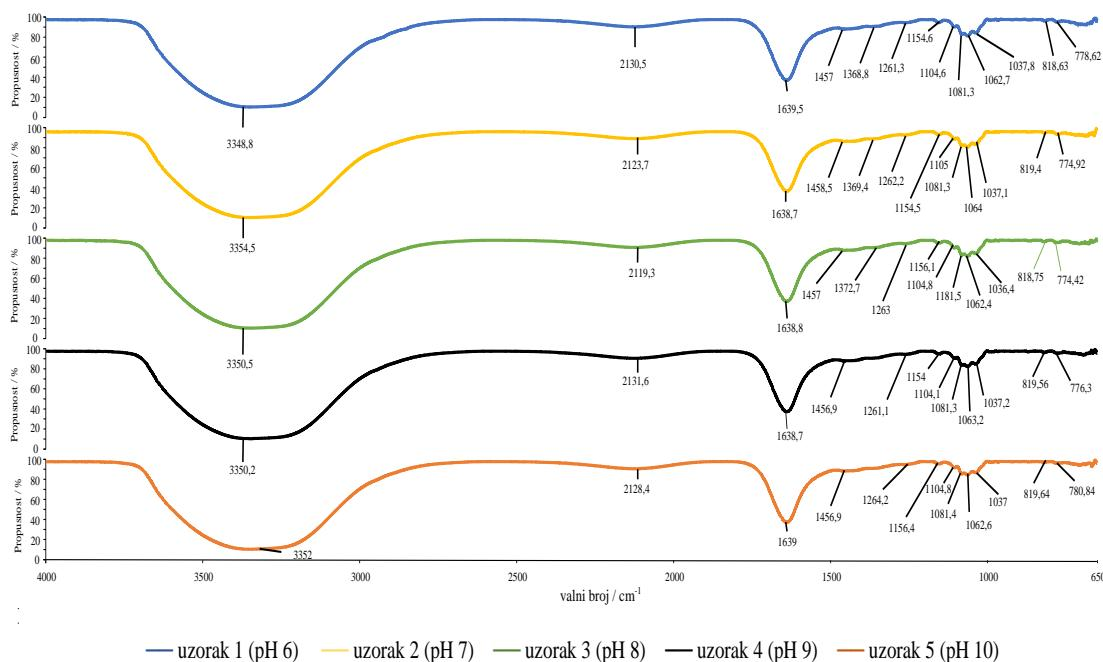
**Slika 23. Zbirni FT-IR spektrogrami uzoraka koloidnog srebra**
