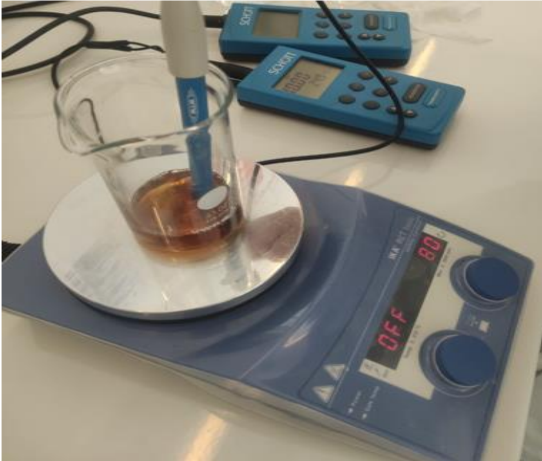
Slika 13. Promjena boje otopine označava pojavu koloidnog srebra
