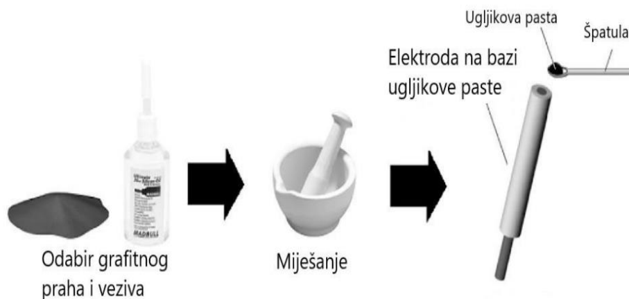
Slika 7. Priprema elektroda na bazi paste od ugljika 14
