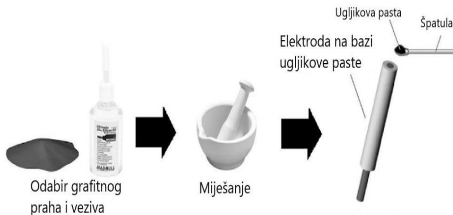
Slika 7. Priprema elektroda na bazi paste od ugljika 14
