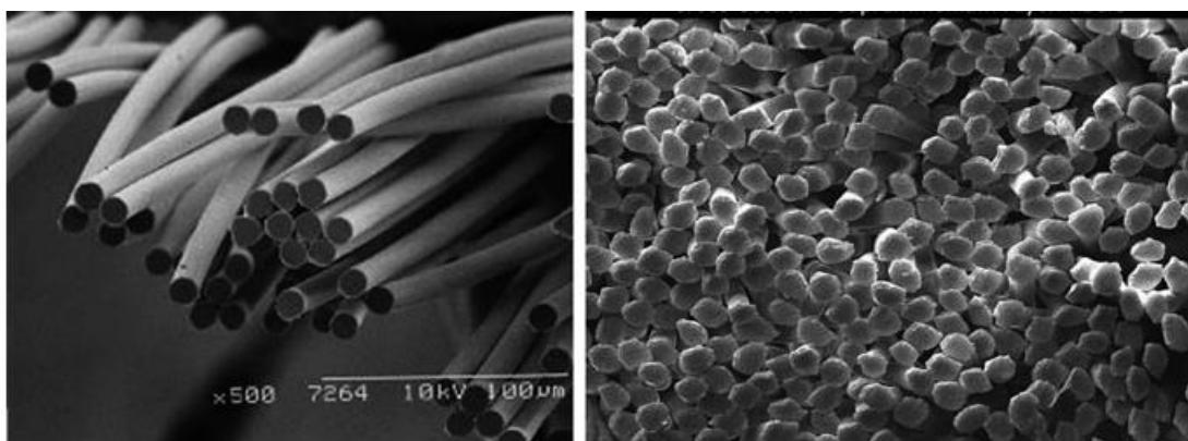
Slika 9. Uzdužni i poprečni presjek kupramonijevog Rayonskog vlakna<sup>20</sup>
