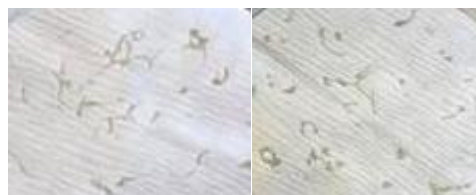
Slika 18. Primjeri regeneriranih celuloznih vlakana iz staničevine u 1M sumpornoj kiselini
