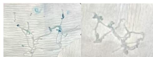
Slika 17. Primjeri regeneriranih celuloznih vlakana iz vate u 1M sumpornoj kiselini
