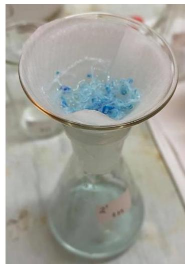
Slika 16. Filtracija i ispiranja regeneriranih celuloznih vlakana
