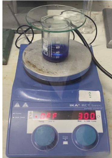
Slika 14. Priprava otopine za kemijsku modifikaciju celuloze
