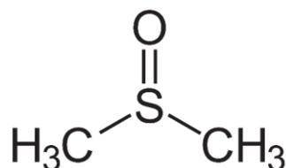
Slika 2. Strukturna formula dimetil sulfoksida<sup>12</sup>
