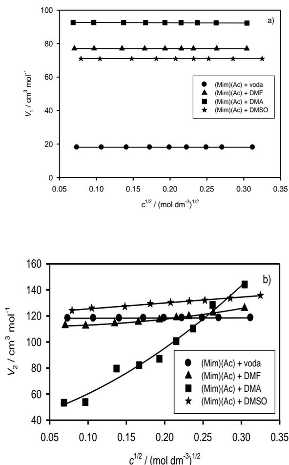
Slika 13. Koncentracijska ovisnost a) parcijalnog molarnog volumena otapala,  $V_1$ , i b) parcijalnog molarnog volumena  $[\text{Mim}][\text{Ac}]$ ,  $V_2$ , u pojedinom otapalu pri  $T = 293.15 \text{ K}$
