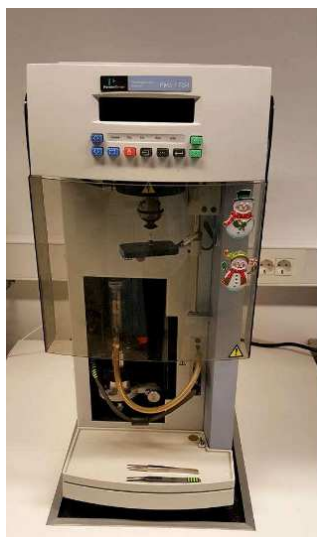
Slika 22. Termogravimetar Pyris TGA.
