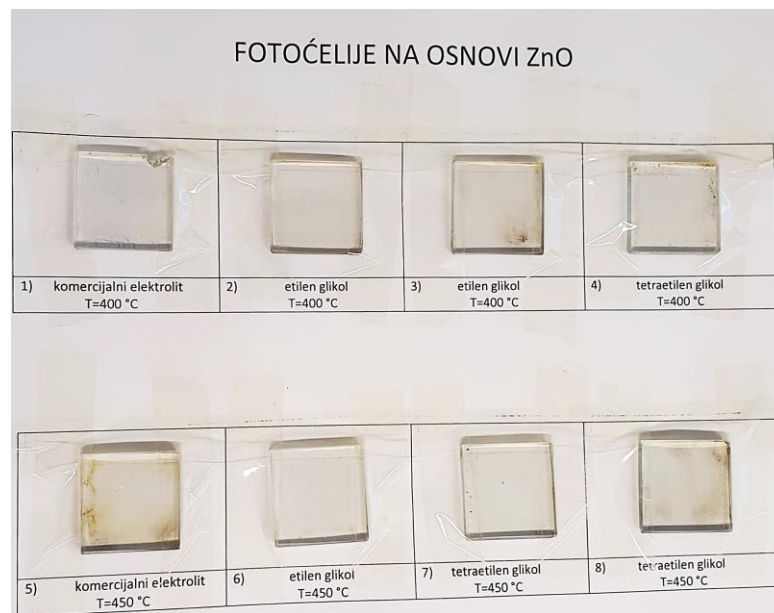
Slika 38. Stakalca zalijepljena ljepljivom trakom
