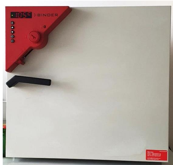
Slika 43. Sušionik za provedbu sušenja stakalaca pri temperaturi 105 °C
