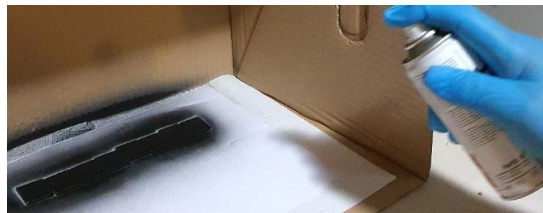
Slika 45. Nanošenje sloja grafita tehnikom naprskavanja
