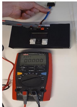
Slika 37. Mjerenje napona i struje u svrhu određivanja površinske otpornosti
