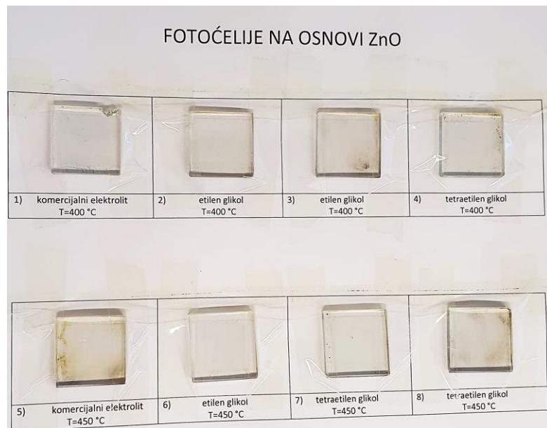
Slika 38. Stakalca zalipljeni ljepljivom trakom
