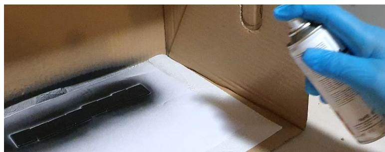
Slika 45. Nanošenje sloja grafita tehnikom naprsakavanja
