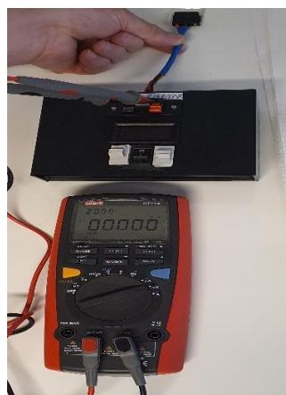
Slika 37. Mjerenje napona i struje u svrhu određivanja površinske otpornosti
