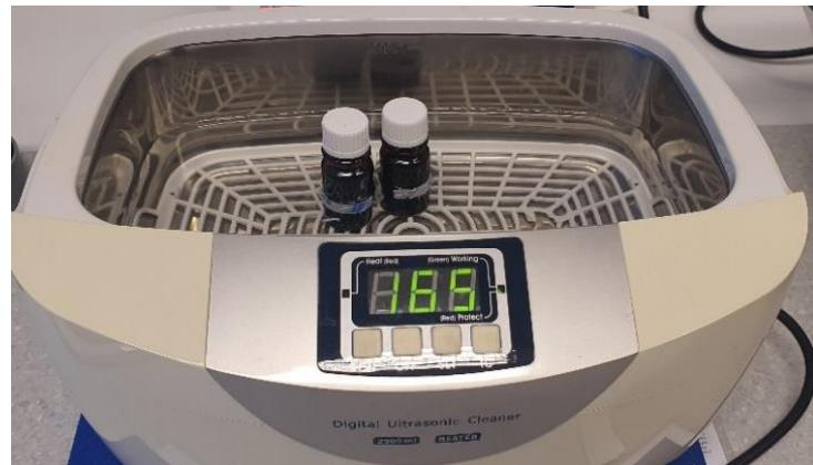
Slika 33. Ultrazvučna kupelj s uzorcima elektrolita
