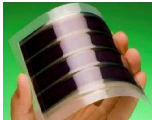
Slika 19. Tankoslojna ćelija na osnovi nanokristaličnog TiO<sub>2</sub><sup>28</sup>
