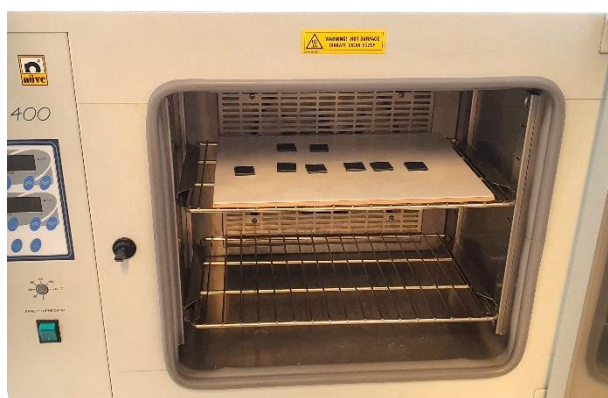
Slika 46. Sušenje sloja grafita u sušioniku pri temperaturi 60 °C
