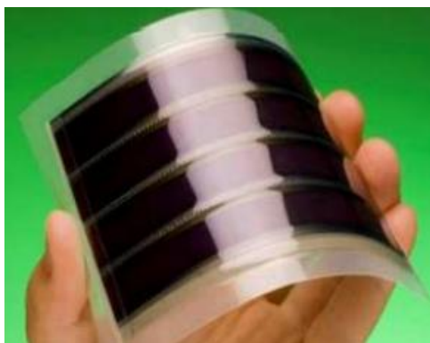
Slika 19. Tankoslojna ćelija na osnovi nanokristaličnog \text{TiO}_2 28
