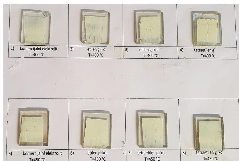
Slika 39. Stakalaca s nanesenim slojem ZnO
