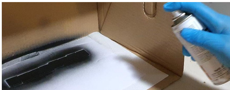
Slika 45. Nanošenje sloja grafita tehnikom naprskavanja
