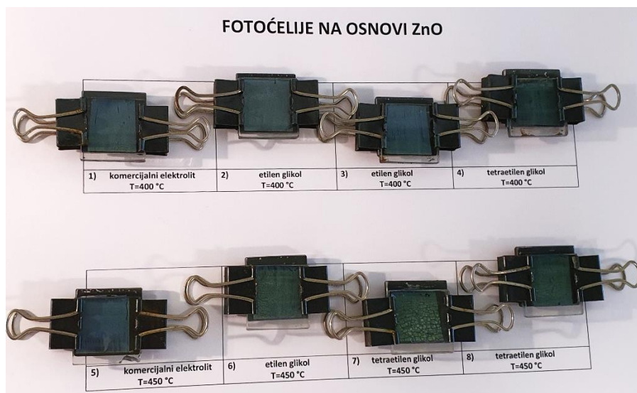
Slika 49. Izrađene solarne ćelije s fotoosjetljivim bojilom
