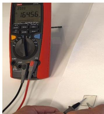
Slika 36. Određivanje vodljive strane stakalca pomoću multimetra
