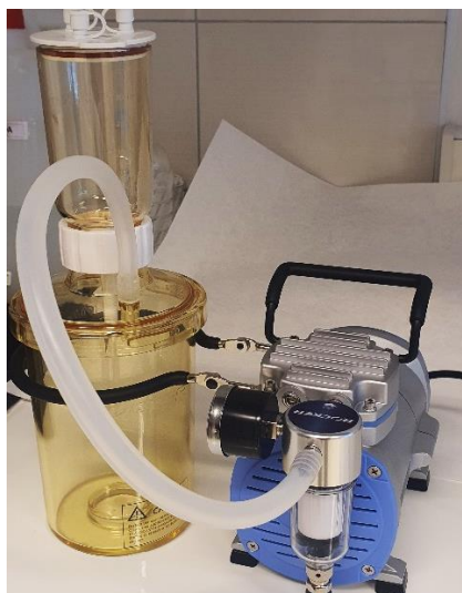
Slika 31. Uređaj za provedbu mikrofiltracije
