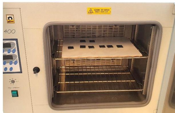
Slika 46. Sušenje sloja grafita u sušioniku pri temperaturi  $60^{\circ}\text{C}$
