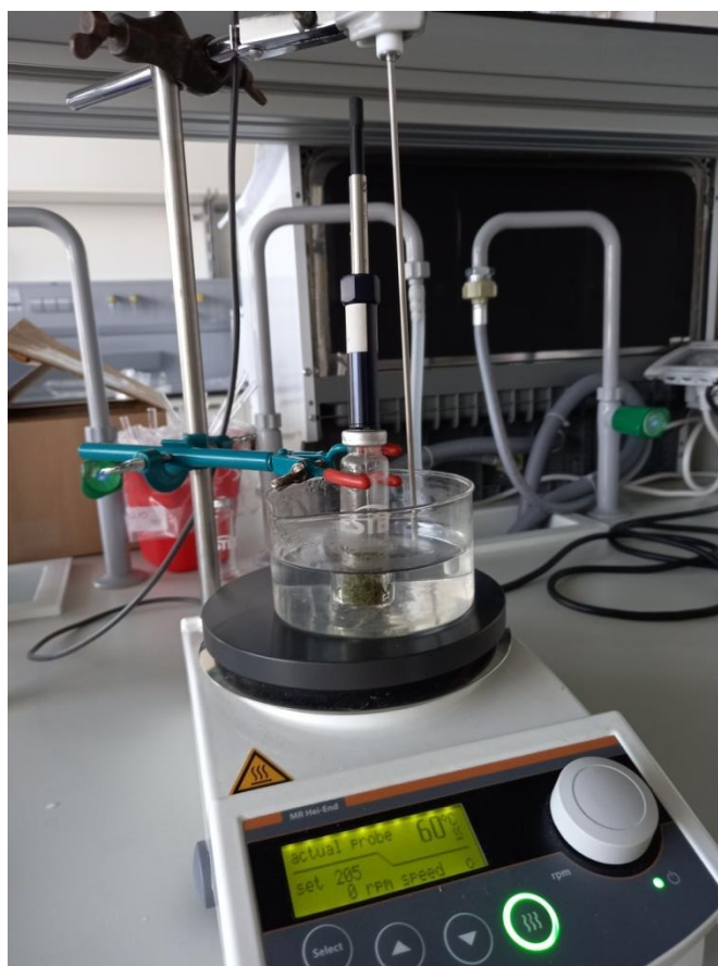
Slika 20. Kondicioniranje uzorka: vialica s uzorkom u vodenoj kupelji postavljenoj na magnetskoj miješalici
