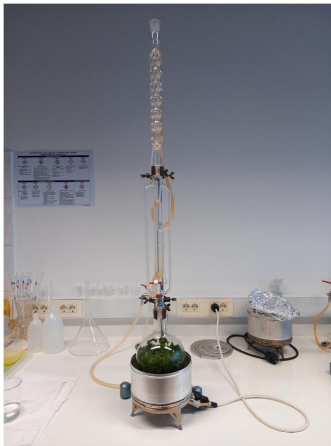
Slika 19. Aparatura za vodenu destilaciju
