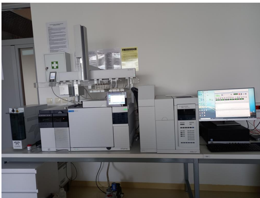
Slika 21. Vezani sustav plinska kromatografija-spektrometrija masa (GC-MS)
