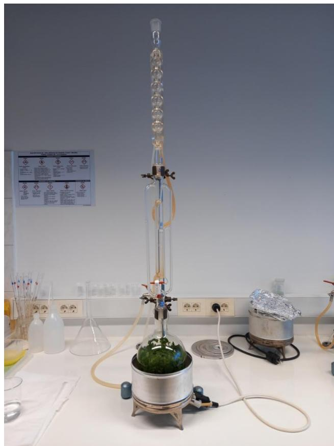
**Slika 19.** Aparatura za vodenu destilaciju
