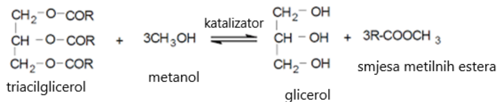
Slika 9. Prikaz procesa transesterifikacije metanolom 25
