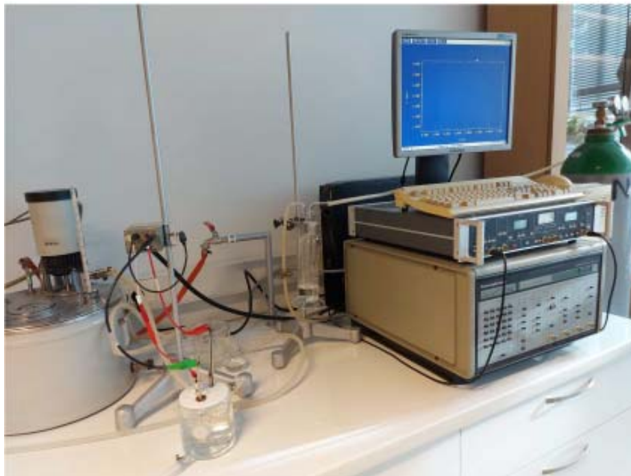
Slika 2.1. Aparatura za provođenje elektrokemijskih mjerenja
