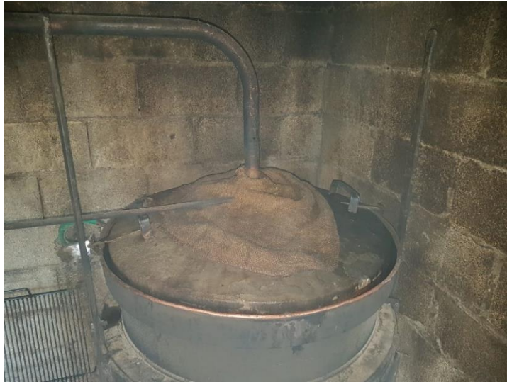
Slika 11. Zatvaranje kotla kapkom
