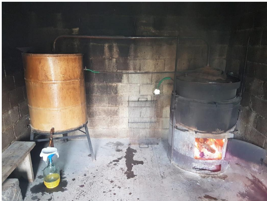
Slika 9. Kotao za destilaciju rakije
