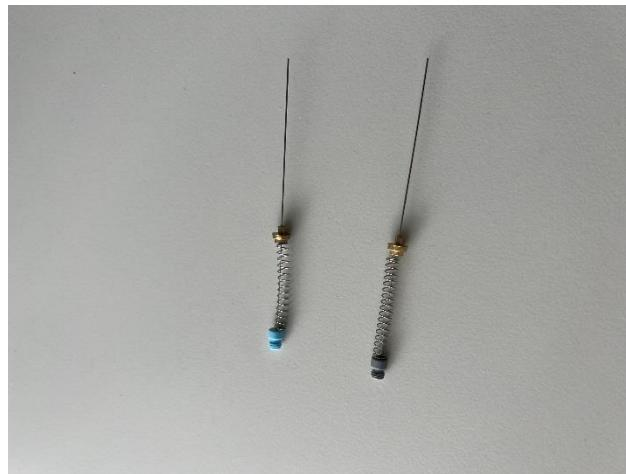
**Slika 6.** Vlakna s ovojnicama 65 µm PDMS/DVB (svijetlo plavo vlakno) i 50/30 µm DVB/Carboxen/PDMS (sivo vlakno)
