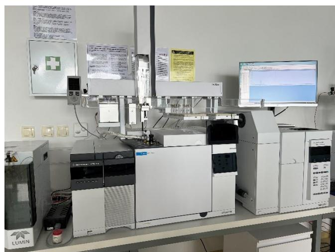
**Slika 8.** Vezani sustav plinska kromatografija-spektrometrija masa (GC-MS)
